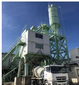
▲生コン事業部所有のフランク。製造した生コンを車に横込みます。
