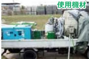
専用塗装機・コンプレッサー・発電機
